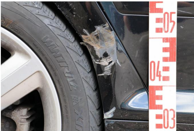
Afbeelding 3: Bruin gekleurde schade op de wielkast van de Audi
