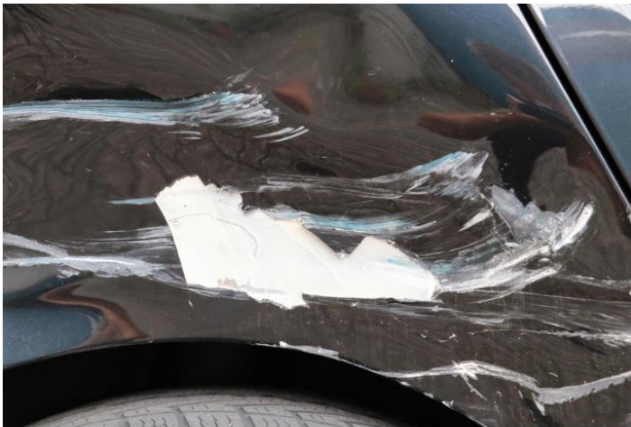
Afbeelding 6: Krassen op het achterscherm lopen niet door en gaan in een curve omhoog
